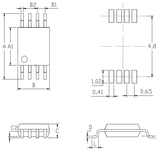
**MSOP8 PACKAGE MECHANICAL SPECIFICATIONS**
